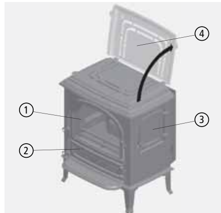
Abb. 4.1 Feuertür, Befülltür, Aschefachtür, Abdeckung
