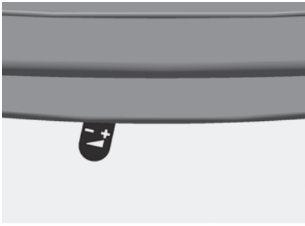
Abb. 4.5 Verbrennungsluft-Schieber ganz links – Verbrennungsluft komplett geschlossen
