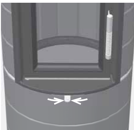
Abb. 4.4 Verbrennungsluft-Schieber, in der Mitte, Betrieb bei Nennwärmeleistung
