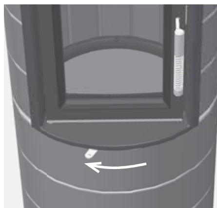
Abb. 4.3 Verbrennungsluft-Schieber, links, ganz geschlossen
