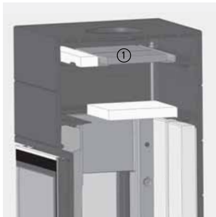
Abb. 4.47 Lage des Katalysators beim CORNA ES, Schnittdarstellung
