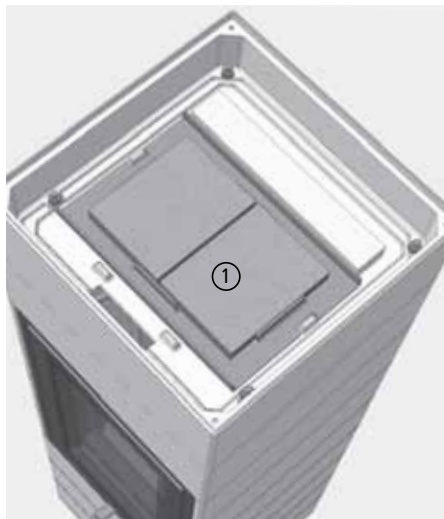
Abb. 4.46 Lage der Katalysatorplatten beim CORNA
