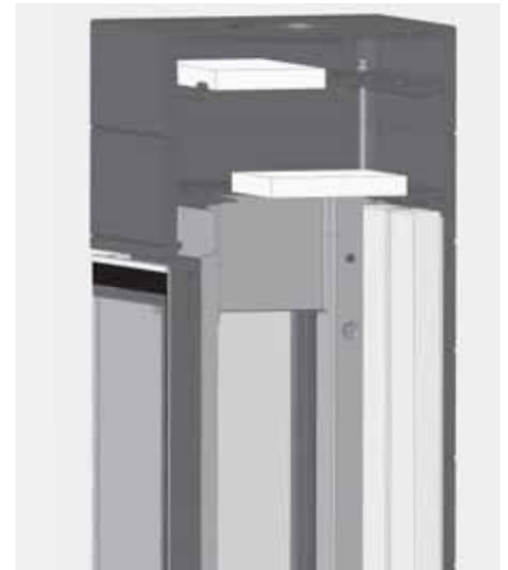
Abb. 4.43 Entnehmen der Umlenkungen (CORNÄ ES, Heizgasführung)
