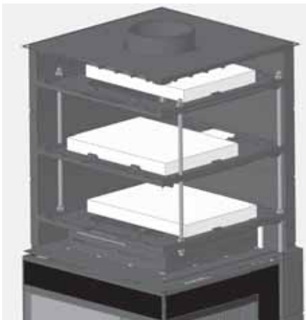
Abb. 4.44 Lage der Umlenkungen beim CORNÄ PS
