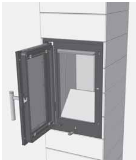
Abb. 4.40 Entnehmen des Bodensteins im Brennraum
