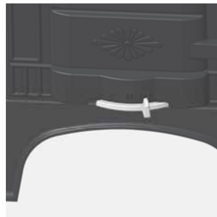
Abb. 4.6 Verbrennungsluftschieber ganz rechts, Markierung „III“, Verbrennungsluft komplett geöffnet, Anheizen
