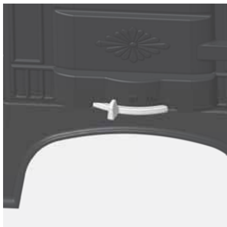
Abb. 4.4 Verbrennungsluftschieber ganz links, Markierung „I“, Verbrennungsluft geschlossen
