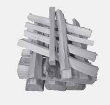
Abb. 4.9 3 zusätzliche Lagen aus dünnen Holzstreifen, Streifen längs, 4 Streifen längs, 4 Streifen diagonal und 2 Streifen längs (insgesamt 10 Streifen, insgesamt 0,8 kg, jeweils ca. 0,8 kg)
