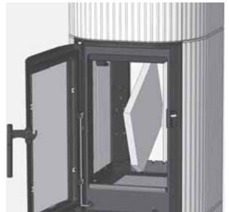
Abb. 4.46 Prallplatte nach vorne gedreht und aus dem Brennraum entnehmen
