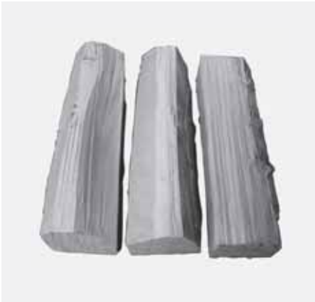
Abb. 4.6 untere Lage: 3 Scheite, 25 cm Länge bei Durchmesser von 6 cm bis 8 cm, längs im Brennraum (insgesamt 2,4 kg, jeweils ca. 0,80 kg)
