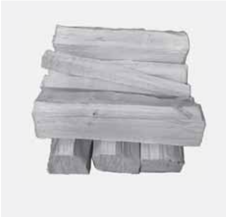
Abb. 4.8 3 dünne Holzstreifen zwischen den beiden äußern Scheiten in der zweiten Lage (insgesamt ca. 0,3 kg, jeweils ca. 0,10 kg)
