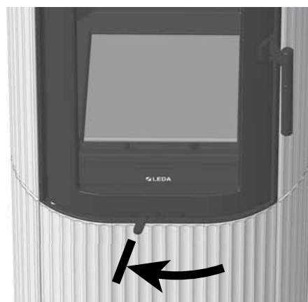
Abb. 4.11 Verbrennungslufthebel ganz links, Verbrennungsluft geschlossen
